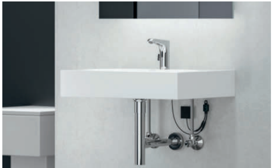
Das SSC Bluetooth®-Modul wird unter dem Waschtisch zwischen Armatur und Stromversorgung gesteckt. So können die Armaturen parametrierbar werden. Wird das Modul wie hier fest installiert, lassen sich Stagnationsspülungen zu individuell festgelegten Zeitpunkten automatisch auslösen.
