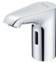
Rubinetteria senza contatto, con controllo a sensore dalle tecnologie innovative Time of Flight (ToF). Insensibili a materiali riflettenti come specchi, gilè di sicurezza ecc. Con interfaccia bluetooth® integrata. Regolazione dei parametri mediante la App SCHELL. Adatto al collegamento rete con il sistema di gestione acqua SWS SCHELL. Alimentazione da rete (alimentatore a spina).
