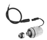
vanne magnétique bistable 6 V pour la désinfection thermique avec système de gestion d'eau SWS de SCHELL. La vanne magnétique peut être installée ultérieurement dans le raccord prévu à cet effet du circuit d'eau. Fonctionnement : l'eau chaude contourne par le bypass la vanne thermostatique. Activation possible via un extendeur de bus câblé SWS BE-K ou un extendeur de bus radio SWS BE-F.
