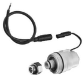
vanne magnétique bistable 6 V pour la désinfection thermique avec système de gestion d'eau SWS de SCHELL. La vanne magnétique peut être installée ultérieurement dans le raccord prévu à cet effet du circuit d'eau. Fonctionnement : l'eau chaude contourne par le bypass la vanne thermostatique. Activation possible via un extendeur de bus câblé SWS BE-K ou un extendeur de bus radio SWS BE-F.
