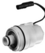
vanne magnétique bistable 6 V pour la désinfection thermique avec système de gestion d'eau SWS de SCHELL. La vanne magnétique peut être installée ultérieurement dans le raccord prévu à cet effet du circuit d'eau. Fonctionnement : l'eau chaude contourne par le bypass la vanne thermostatique. Activation possible au moyen d'un extendeur de bus radio SWS VITUS BE-FV.
