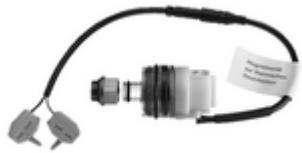
La vanne magnétique peut être installée ultérieurement dans le raccord prévu à cet effet d'un circuit d'eau. Fonctionnement : l'eau chaude contourne par le bypass la vanne thermostatique. L'activation se fait via un raccordement sur site (système de gestion du bâtiment, interrupteur à clé, etc.).
