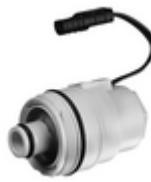
vanne magnétique bistable 6 V pour la désinfection thermique avec système de gestion d'eau SWS de SCHELL. La vanne magnétique peut être installée ultérieurement dans le raccord prévu à cet effet du circuit d'eau. Fonctionnement : l'eau chaude contourne par le bypass la vanne thermostatique. Activation possible au moyen d'un extendeur de bus radio SWS VITUS BE-FV.
