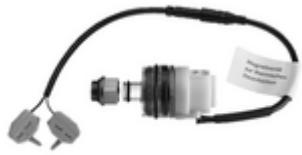
La vanne magnétique peut être installée ultérieurement dans le raccord prévu à cet effet d'un circuit d'eau. Fonctionnement : l'eau chaude contourne par le bypass la vanne thermostatique. L'activation se fait via un raccordement sur site (système de gestion du bâtiment, interrupteur à clé, etc.).
