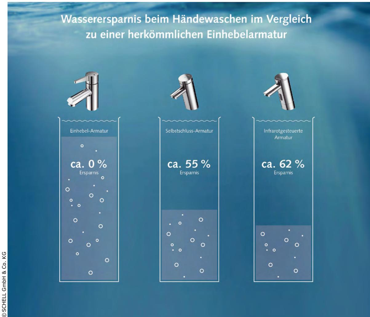
Bei berührungslosen, elektronischen Armaturen fließt nur dann Wasser, wenn es wirklich benötigt wird. So lassen sich im Vergleich zu regulären Einhebelmischern bis zu 62 Prozent Wasser sparen.
