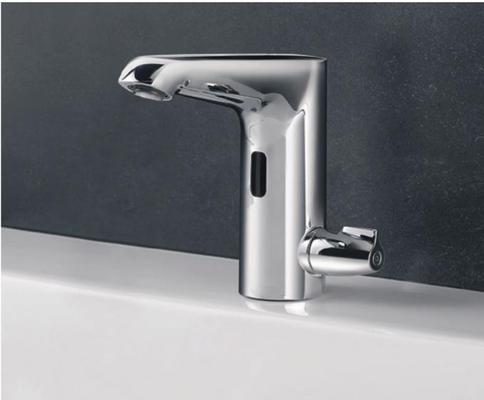
Mithilfe eines Infrarot-Sensors wird der Wasserfluss an einer Armatur automatisch ausgelöst und nach einer kurzen Nachlaufzeit gestoppt, sobald die Hände den Sensorbereich wieder verlassen.
