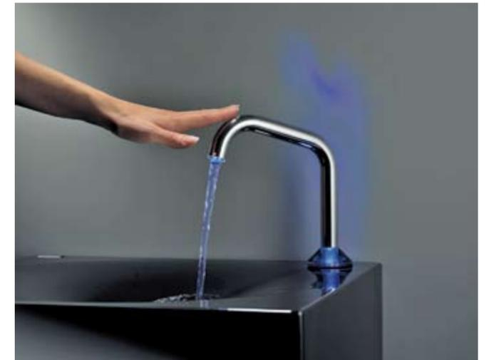
KWC USO reagiert auf eine Berührung des Auslaufs und zeigt über Farbsignale die Wassertemperatur an: Einmal Antippen kalt (blau), zweimal Antippen warm (orange), dreimal Antippen heiß (rot). Nach zehn Sekunden stellt das Wasser automatisch ab. Möchte man das Wasser vorzeitig abstellen, einfach den Auslauf einmal berühren.
