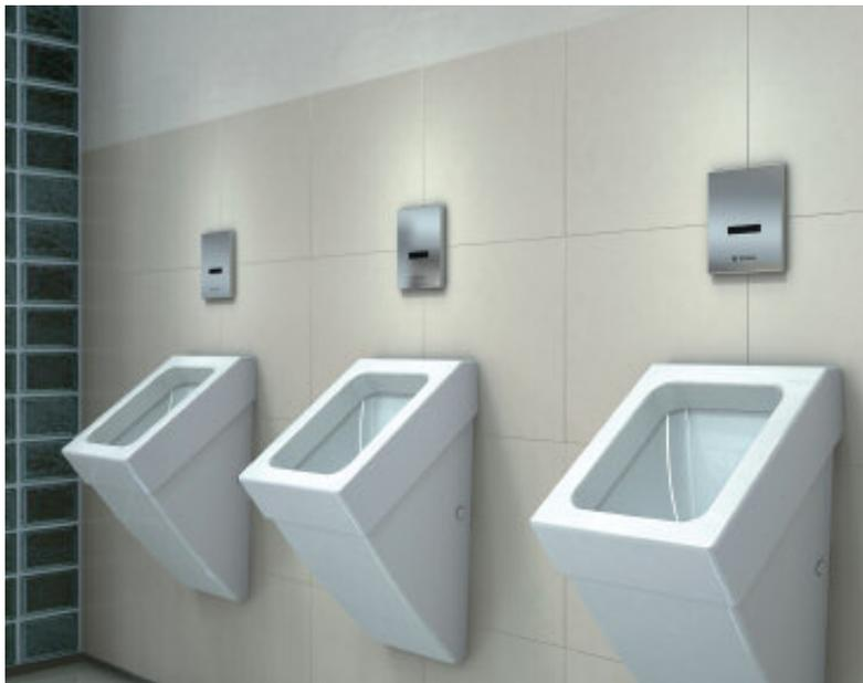
Bild 6 • Druckspüler sind heute so leise wie Spülkästen und verbrauchen auch nicht mehr Wasser als diese, fördern jedoch durch eine deutlich erhöhte Fließgeschwindigkeit in den Zuleitungen die Trinkwasserhygiene.
