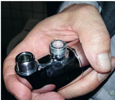
Bild 6: Die Ursache überhöhter Legionellenzahlen im Kaltwasser: Ein Schlauchanschluss hatte den zu hoch im Eckventilthermostaten positionierten Rückflussverhinderer vom Typ EB zerstört. Dadurch konnte Warmwasser auf die Kaltwasserseite strömen. 28000 Legionellen pro 100 ml im Kaltwasser waren die Folge.
