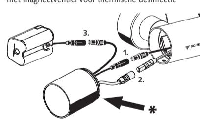
\*Opgelet: Voor de montage van de Bluetooth®-module aan de kraan, dient u het af fabriek ingestelde wachtwoord af te lezen en te noteren.
