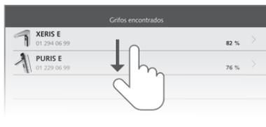
Si no aparece inmediatamente un grifo operado con batería, deberá activarse manualmente el grifo. A continuación, se debe reiniciar la búsqueda de grifos.
