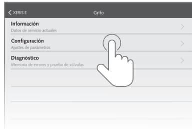
Como protección frente a un acceso no autorizado, asignar una contraseña personal al módulo SSC Bluetooth®. La activación o modificación de la contraseña se realiza en: Módulo Bluetooth® > Configuración > Contraseña: activada/desactivada. El código por defecto es 00000000.
