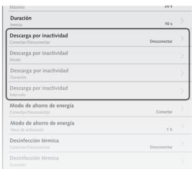
Las posibilidades de ajuste aquí descritas para la descarga por inactividad se refieren solo al grifo y no a la descarga por inactividad regulable en «Higiene».
