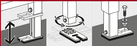
Montagevoeten Hoogte-instelling van de montagevoeten voor een vloeropbouw tot max. 200 mm. Afhankelijk van de montagesituatie kan de voetplaat 4 x 90° draaien. De bevestigingsmaterialen maken deel uit van de levering.
