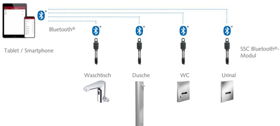
Mit den SCHELL Systemlösungen wird eine neue Ära beim Betrieb von öffentlichen Gebäuden eingeläutet. Egal ob die Parametrierung einzelner elektronischer Armaturen oder die zentrale Steuerung aller Installationen via Server, die digitalen Lösungen von SCHELL bieten stets effizienten Bedienkomfort.
