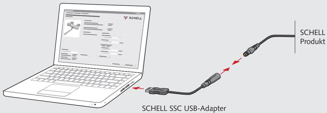
Die SCHELL SSC USB-Software dient zur komfortablen Einstellung der Funktionsparameter an allen elektronischen SCHELL Produkten. So können z.B. die Laufzeit, die Stagnationsspülzeit und die Stagnationsspül-Intervalle parametrisiert und die entsprechende Diagnose durchgeführt werden.
