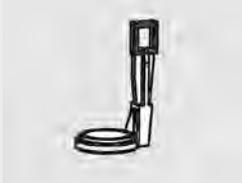
Etrier de levage pour cloche avec bague
