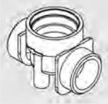
**Corps pour vanne magnétique**L = 55 mm
