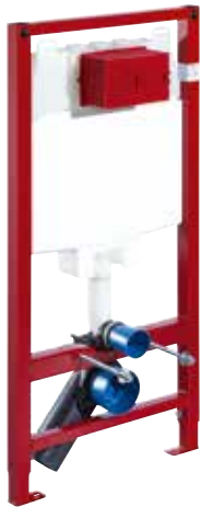
Modulo WC MONTUS (modello C 80) H 115 cm con cassetta di cacciata sotto intonaco da 8 cm
