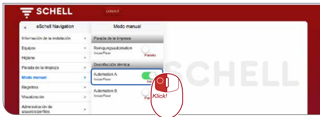
Fig 12: Iniciar desinfecciones térmicas
