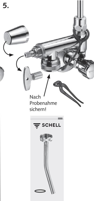
Probenamerohr und Dichtung im Schutzbeutel aufbewahren!
