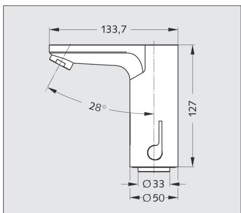
**(DE)** Fließdruck (min - max): 0,5 - 5,0 bar
