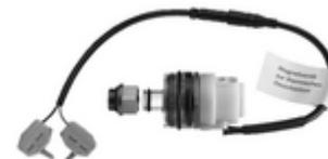
La electro-válvula puede instalarse a posteriori en la conexión prevista de un circuito de agua. Funcionamiento: El agua caliente se canaliza por fuera de la válvula termostática. El control se realiza por medio de la conexión proporcionada por el cliente (sistema de control central del edificio, interruptor, etc.).
