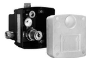
Für Unterputz-Duscharmaturen LINUS D-SC-V. Manuelle Auslösung mit automatischem Schließvorgang. Mit abgedichteten Gehäusedurchführungen und innenliegender Vorabspernung.
